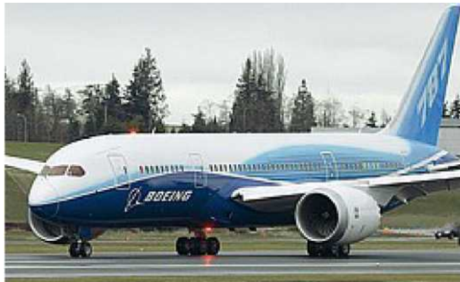
Gigante leggero Il Boeing 787 Dreamliner è realizzato per oltre il 50% in fibra di carbonio e pesa il 20% in meno di un aereo in alluminio, con notevoli risparmi energetici. In alto, Claudia Gerini in un'immagine di Fabio Lovino
